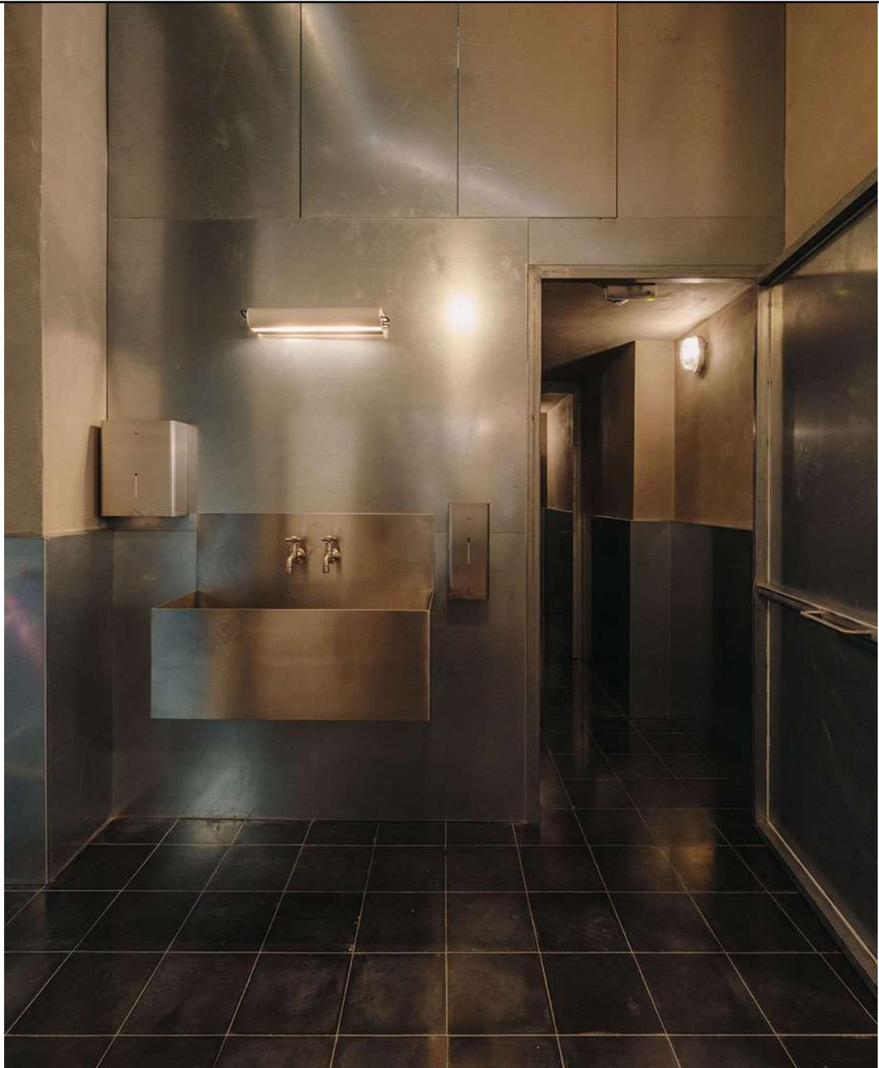
Por último, los baños se ubicaron en el fondo de la sala. Su interior es sobrio e industrial para su fácil mantenimiento, y cuenta con un zócalo de chapa galvanizada, picas de acero diseñadas a medida por el estudio, y espejos de acero pulido.
